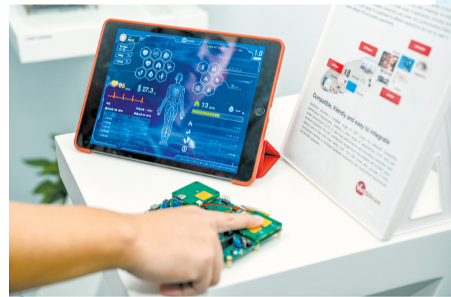
▲芯原微电子自主研发的新健康平台 Veri-health,其传感器检测的数据可以在芯片内进行计算,并把结果通过蓝牙传输到平板电脑上。
