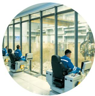
▲5月25日,在海口市生活垃圾焚烧发电厂,工作人员操作抓斗将垃圾投入焚烧炉。
