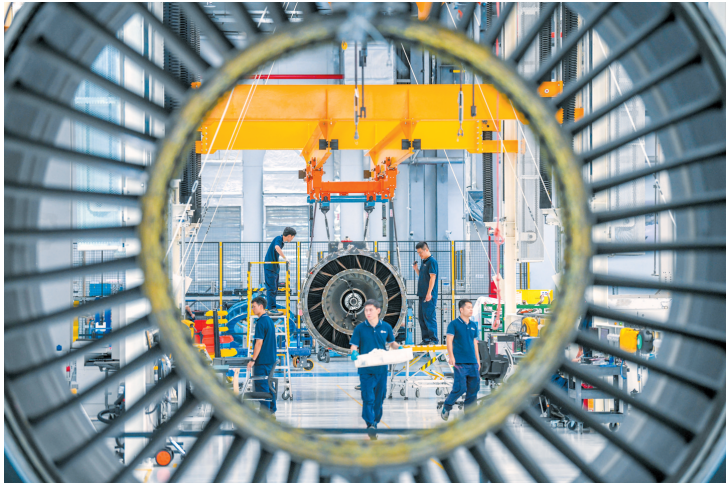
空港综合保税区内,海口美兰空港吉耐斯航空发动机维修工程有限公司工作人员正对一台Genx-1B型号航空发动机进行“体检”。 本报记者 苏弼坤 摄
