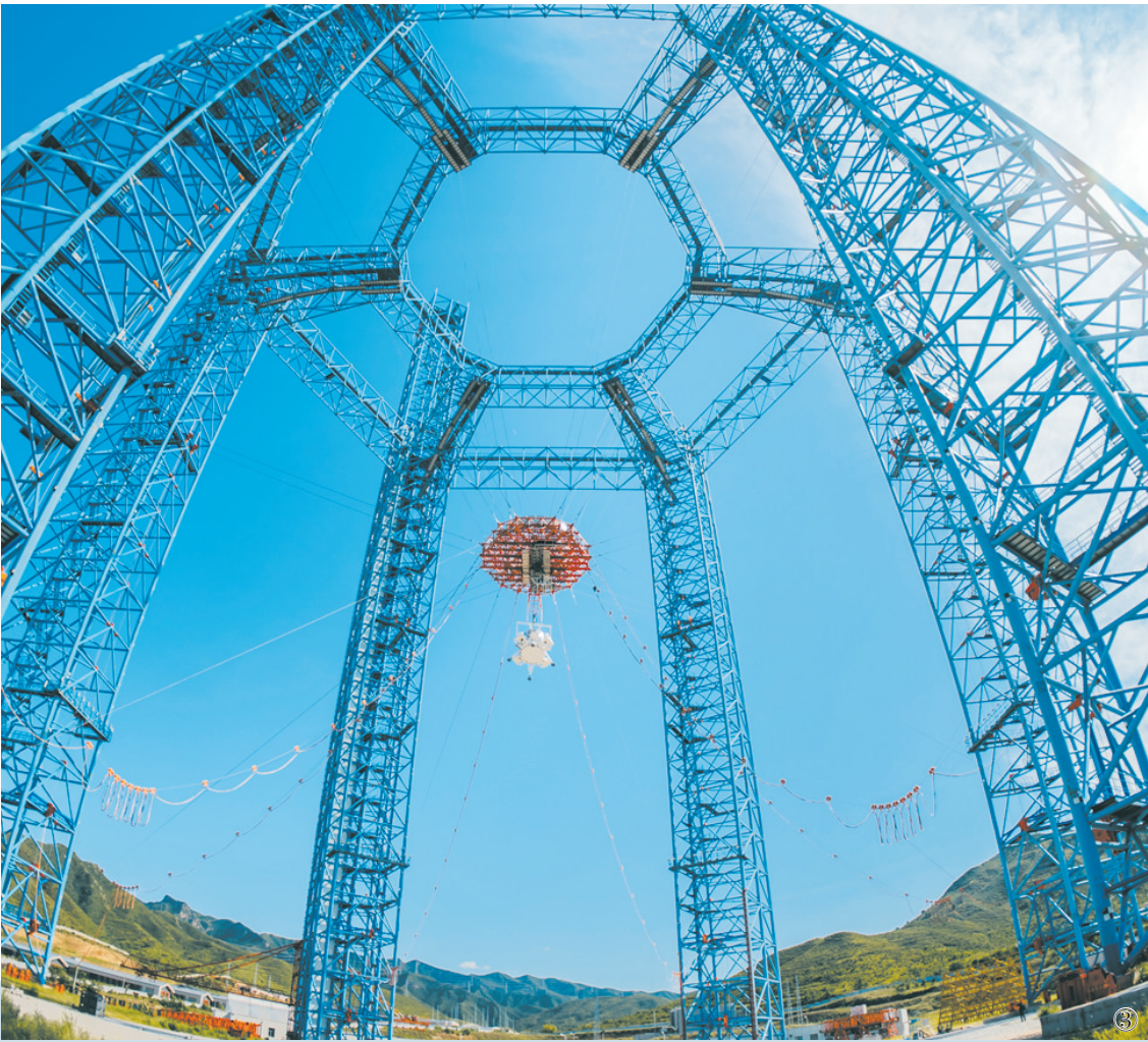
图123:揽月月面着陆器在地外天体着陆试验场进行测试(资料照片)。
