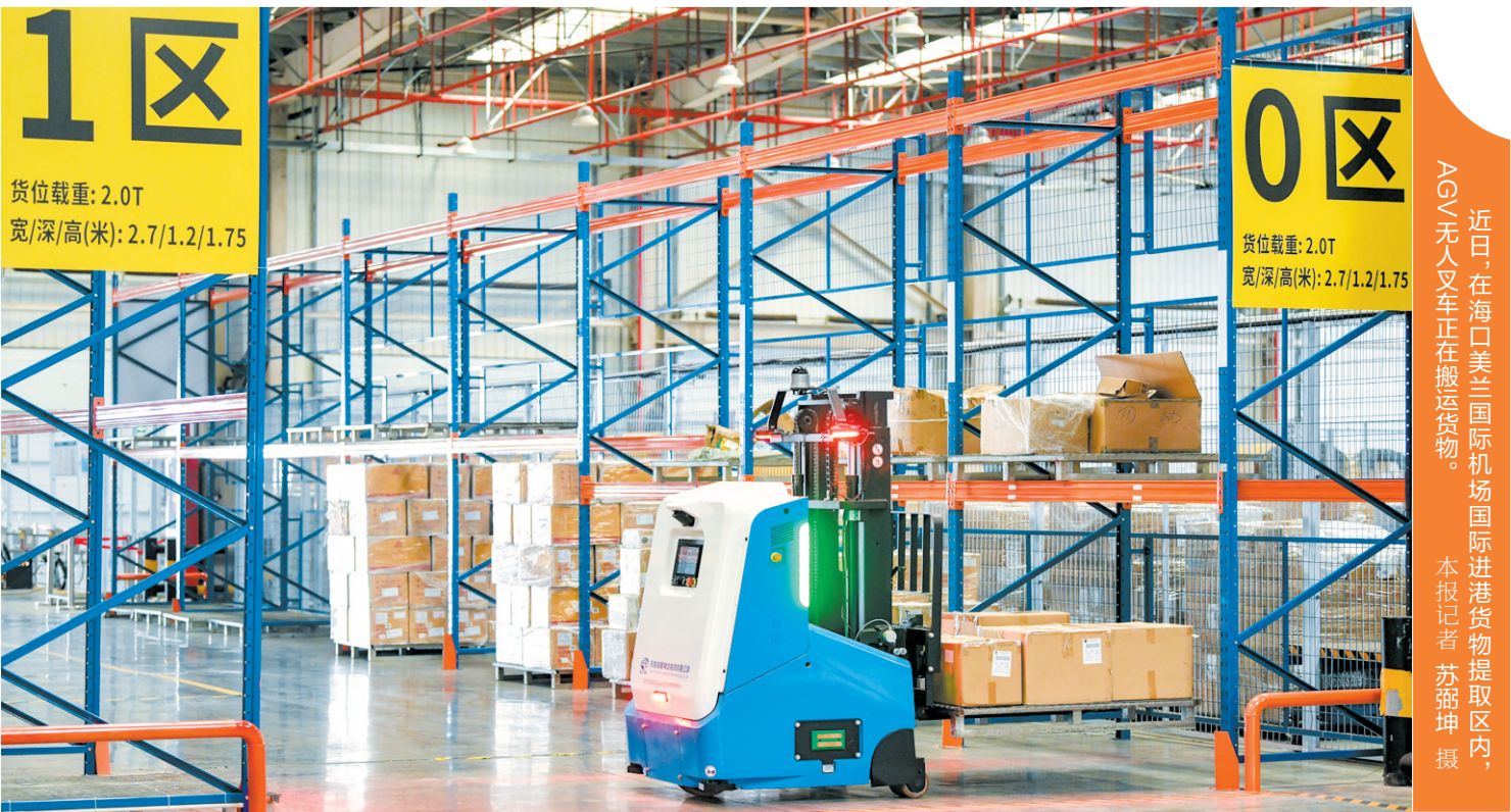
近日,在海南控股旗下海口美兰国际机场国际进港货物提取区内,一台蓝色的无人叉车以毫米级的精度,沿着预设通道和既定路线,在林立的货架与密集的货物间灵活转向,精准叉取货物并运送至指定区域。这正是美兰机场首台试运行的AGV无人叉车。
