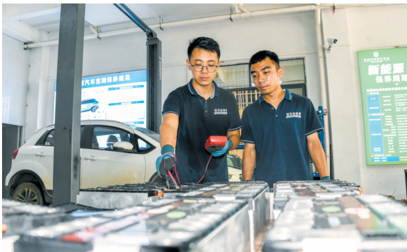
▲在“新能源汽车修师”劳务品牌实训基地——海南福诺新能源汽车服务有限公司,新能源汽车修师正在检查三元锂电池的电芯电压。 本报记者 康登淋 摄
