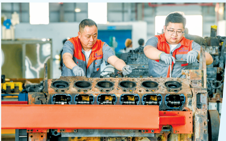
▲海口综保区的中车国际车辆产业(海南)有限公司生产车间内,工作人员加紧维修来自境外的矿卡柴油发动机。
