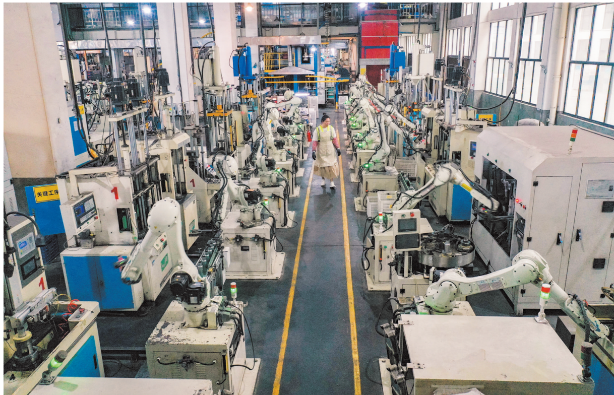
2026年6月16日，在浙江省永康市浙江飞剑集团有限公司数字化工厂智能生产线上，工业机器人在加工保温杯（无人机照片）。 新华社发
