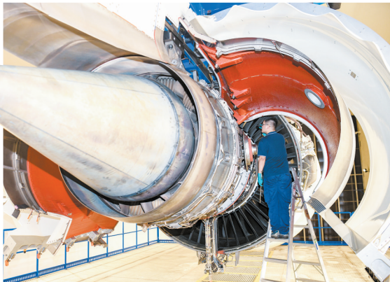
海口美兰空港吉耐斯航空发动机维修工程有限公司试车中心,工作人员对一台飞机发动机进行试车前的准备。
