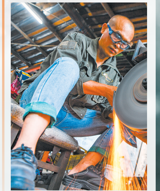
▲梁君使用砂轮打磨刀坯。
